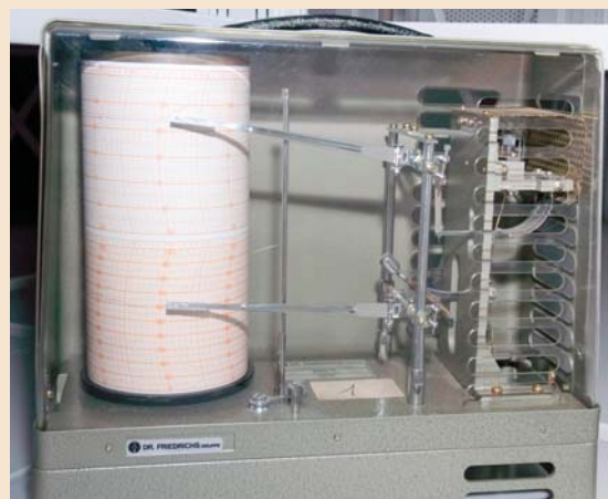
Fig. 14 – Termo-higrógrafo: aparelho para registo dos valores de temperatura e humidade relativa, num determinado espaço.
