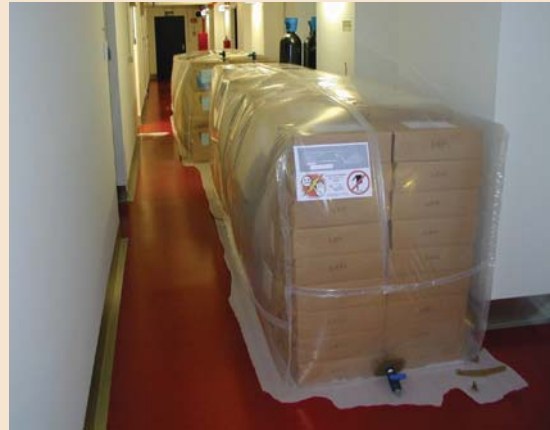
Fig. 12 – Expurgo da documentação, utilizando o método de «bolha de anóxia». Este sistema ecológico tem por finalidade eliminar os agentes nocivos para os documentos.
