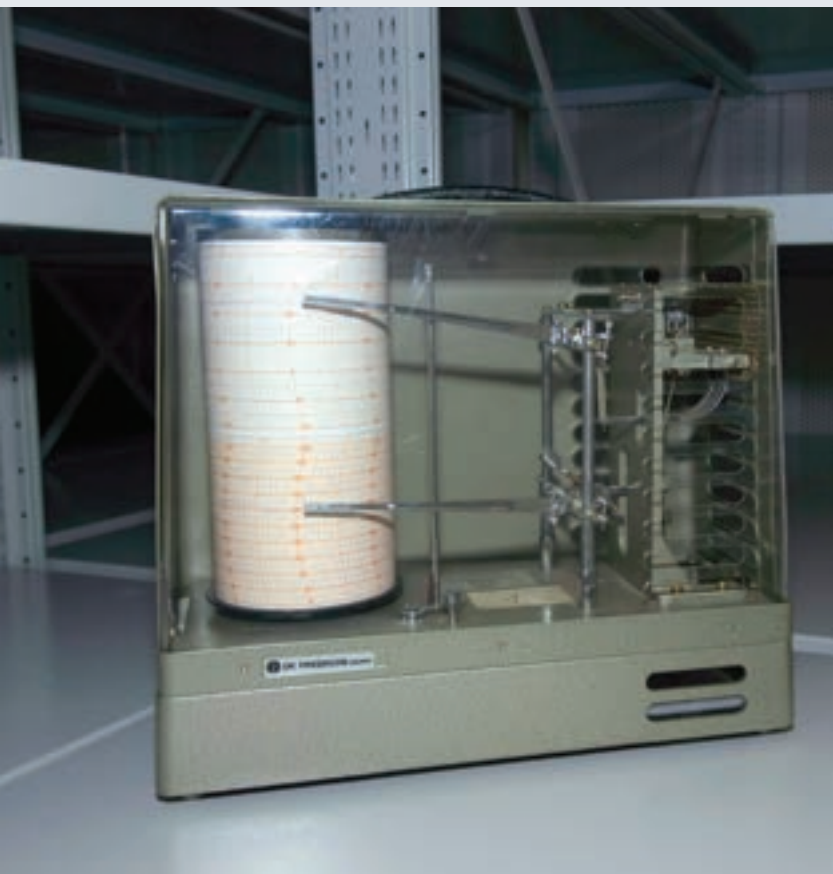
Termo-higrógrafo: aparelho para registo dos valores de temperatura e humidade relativa, num determinado espaço.
